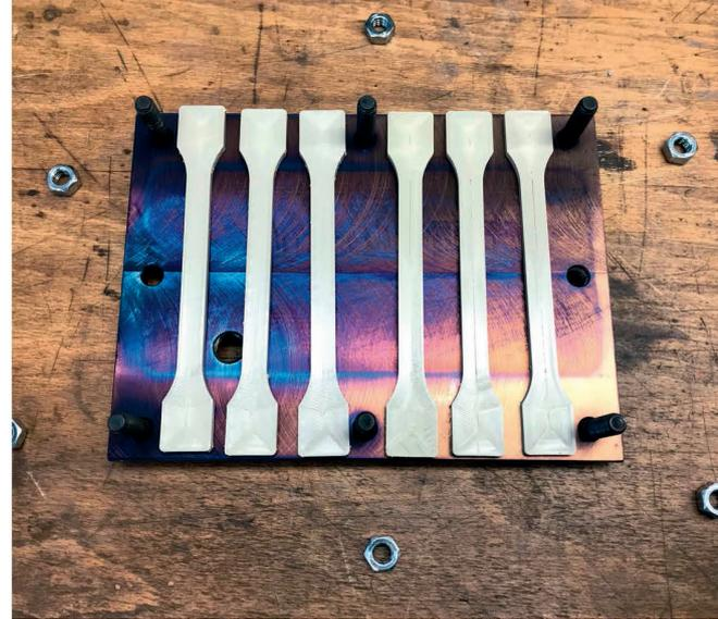
Durch die Nachbehandlung im Muffelofen konnten der Kristallisationsgrad und die mechanischen Kennwerte der Probekörper stark verbessert werden. © Dennis Prigann, PuK
